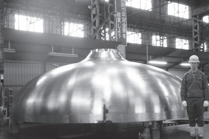
▲蒸気発生器の上蓋(提供:日本製鋼所室蘭製作所)
