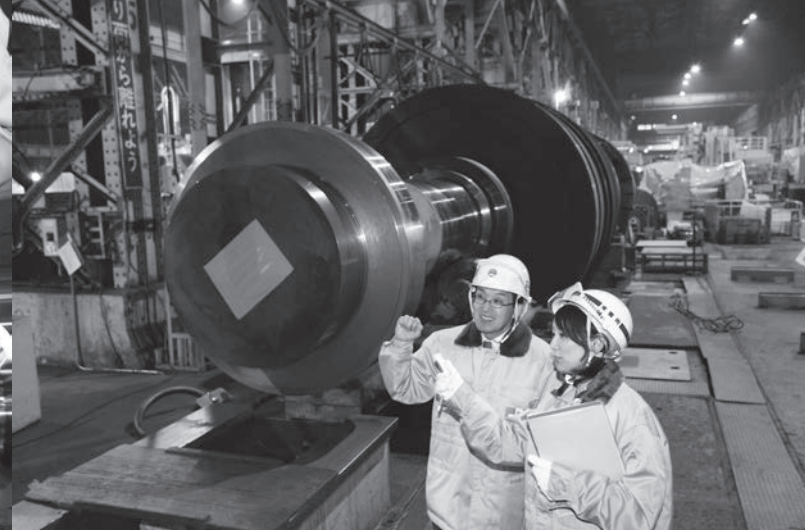
▲高田さんの後ろに見えるのは、機械加工中の一体型低圧タービンロータシャフト
