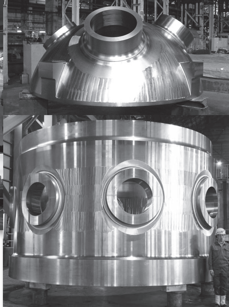
▲原子炉压力容器用の一体型上部胴(提供:日本製鋼所室蘭製作所)
