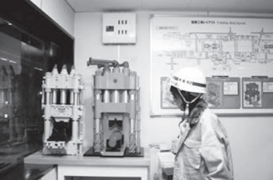
▶水圧プレス の 1/25縮尺模型。 1940年のドイツ製10000t水圧プレス(左)を、 2003年リニューアルして新たに設計・製造した 14000t水圧プレス(右)
