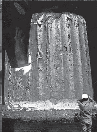
▲世界最大級、600t鋼塊 （提供：日本製鋼所室蘭製作所）
