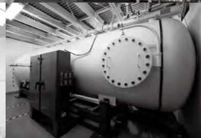
▲ペレトロン年代測定装置の心臓部である加速器タンク。500万ボルト程度の電圧でイオンを加速し、いろいろな核種の超高感度の質量分析を可能にする
