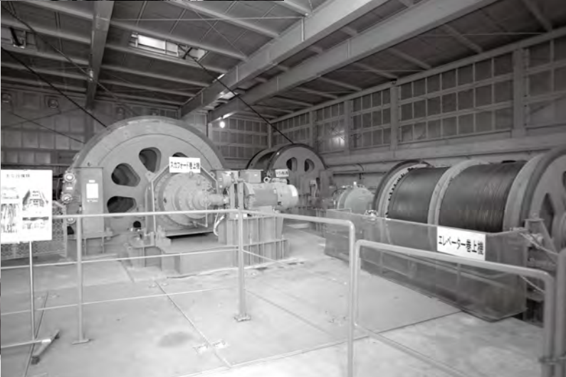
瑞浪の地上設備。防音ハウス(写真上)内には立坑掘削のための槽設備(下右)があり、隣接の建屋には掘削用巻上設備(下左)があった。構内には排水処理設備(左)も設けられている。また東濃地科学センターでは、数km～数十km四方の範囲の地下水流動を対象とした広域地下水流動研究も行っており、ボーリング調査などのデータを用いて地下水の流れを解析している。
