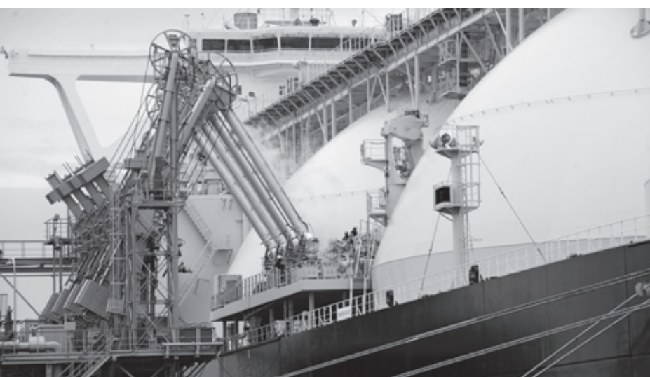
LNG 船エビスからの燃料受け入れ作業
