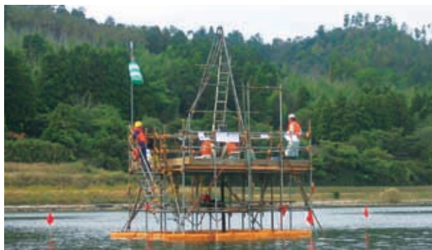
若狭湾での津波の痕跡を調べるボーリング調査
