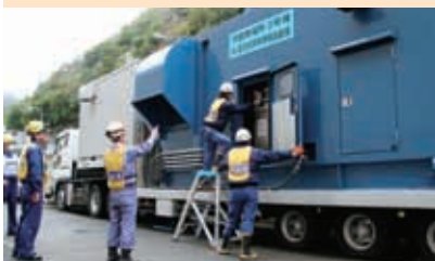
空冷式非常用発電装置を高台に設置
