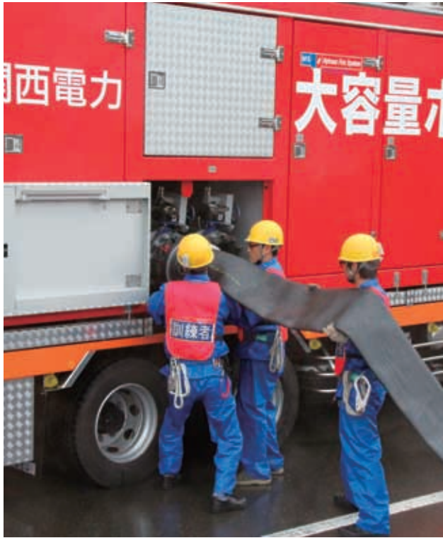
水源多様化策として消防ポンプなどに加え、海水を使う大容量ポンプを設置
