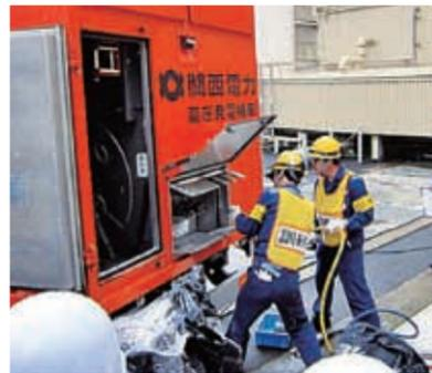
必要な設備に電気を供給するため、電源車から電源盤にケーブルを接続、電源を復旧する訓練
