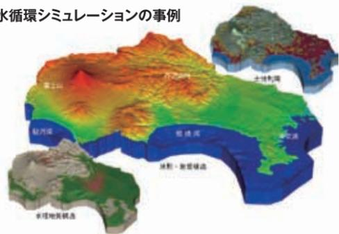
真ん中の図は、神奈川県を中心とし東京湾から富士山まで含む領域の地形モデル、左下の図は地下の地質・水理構造、右上の図は地表の土地の状態（森林、田畑や都市域）を表している。地上4km程度（富士山頂）から地下4kmまでがモデル化され、全体で130万個程度の格子に分割されている。このモデルは広域を対象としているが、地層処分に関わるシミュレーションでは、内部の人工バリアも含め、より細かな離散化を行い、核種移行の計算に適用できる。地形の変化、海水準の変化なども与えることができる。
