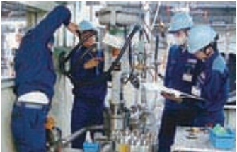
実機と同型の弁を使った分解点検訓練のようす
