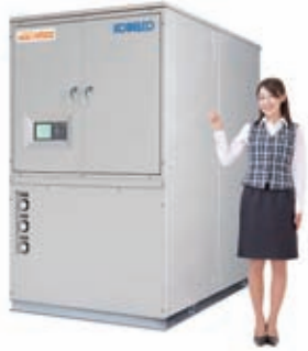
「HEM-HR90」：90℃温水と7℃冷水の同時供給時の総合COPは4.5
