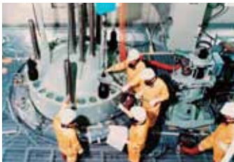
実機と同等の原子炉容器を使い、上蓋のボルト締付け作業を訓練
