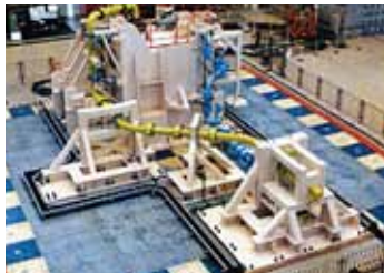
振動台での主蒸気配管試験
