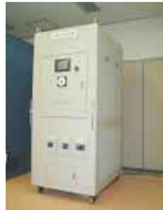
12kVA級SiC3相インバータ装置
