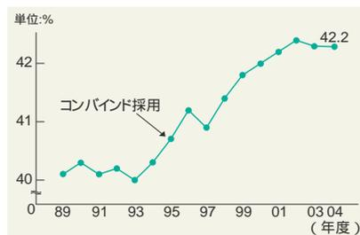
近年、熱効率54%の高効率なコンバインドサイクル発電を導入していますが、旧来の設備も稼働していることから、全火力発電所の総合熱効率は42%程度となっています。
