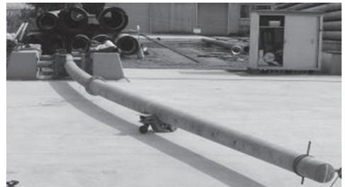
撤去したコンクリート電柱の曲げ破壊試験
