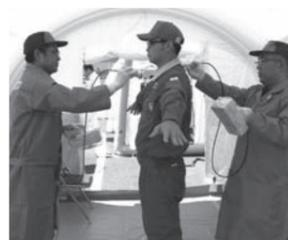
放射線検出器による汚染検査(美浜町)
