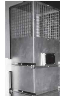
静的触媒式水素再結合装置(イメージ)
