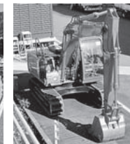
瓦礫撤去用油圧ショベル
