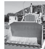
瓦礫撤去用ドーザーショベル
