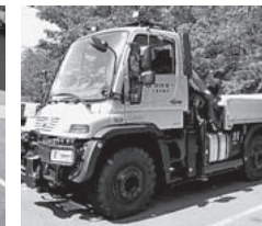
悪路での作業に適したクレーン付大型運搬トラック
