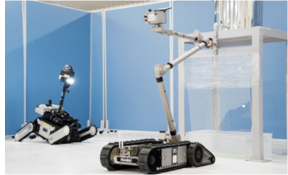
遠隔操作資機材による操作訓練
