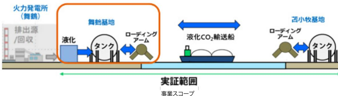
※ CCUS研究開発・実証関連事業/苫小牧におけるCCUS大規模実証試験/CO<sub>2</sub>輸送に関する実証試験/CO<sub>2</sub>船舶輸送に関する技術開発および実証試験
