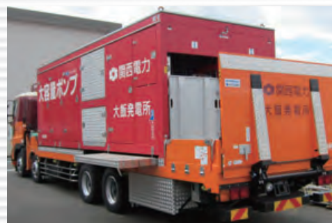
大容量ポンプ
