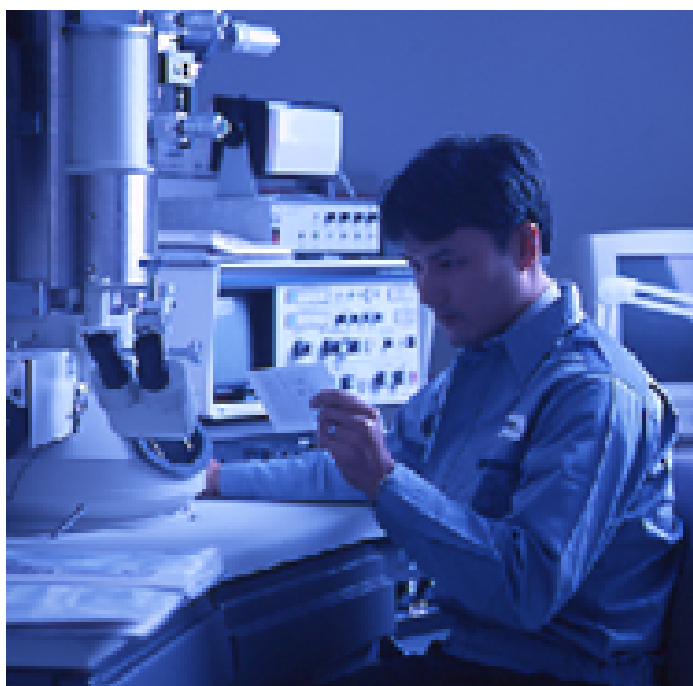
電子顕微鏡による金属疲労検査
