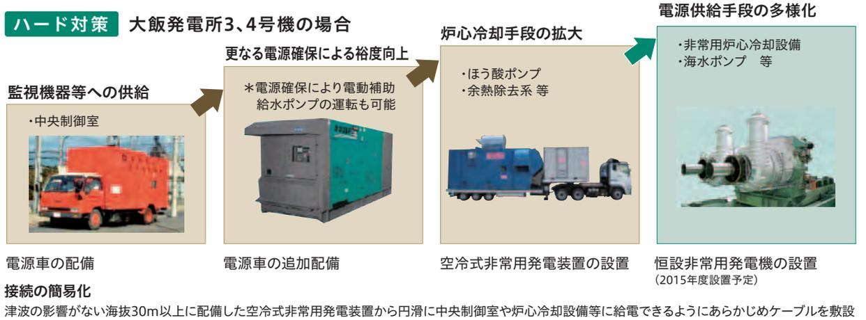
**ソフト対策 配備した電源車や空冷式非常用発電装置をすみやかに必要な箇所に接続するための対策**
