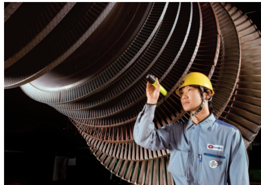
発電所のタービン点検作業
