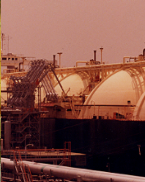
LNG ship and loading arms
