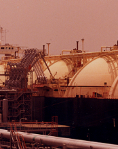
LNG ship and loading arms
