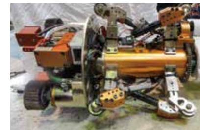
共同研究で製作した配管内面研磨除染装置
