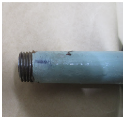
接続部の手入れ後
