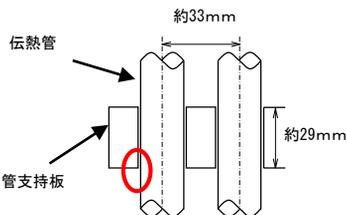
伝熱管の拡大平面図
