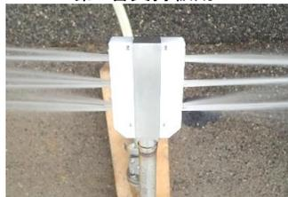
第3～6管支持板用(噴射ノズルを改良)
