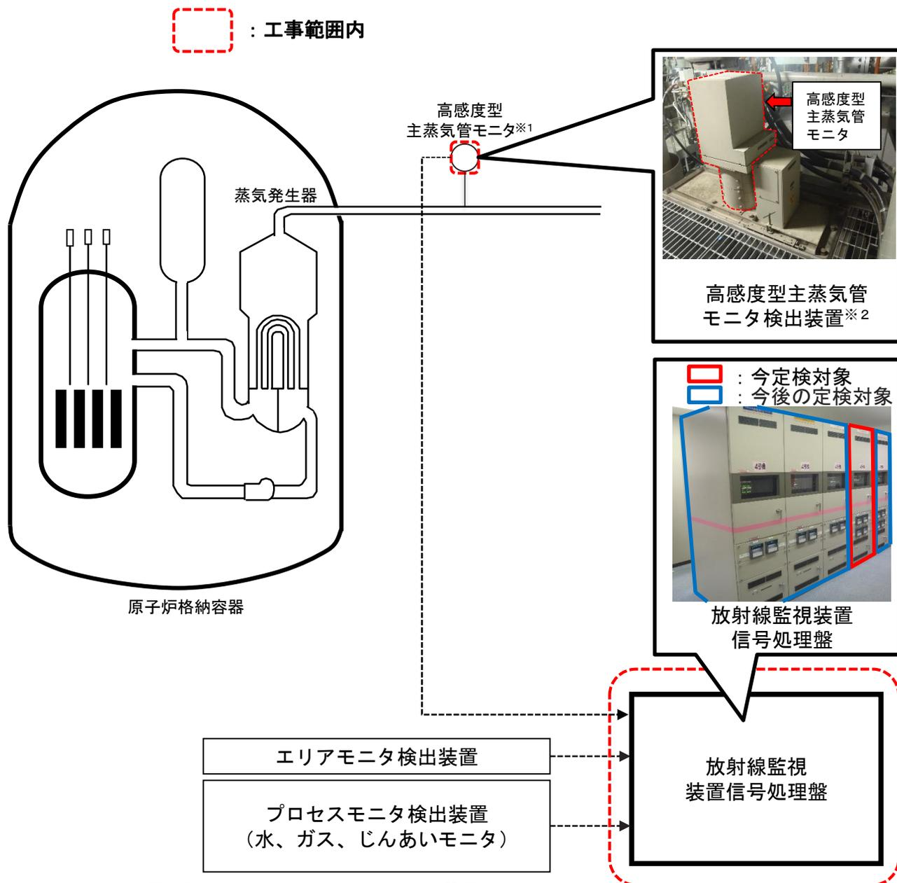
※1：各蒸気発生器（計4台）の主蒸気管に1台ずつ設置
