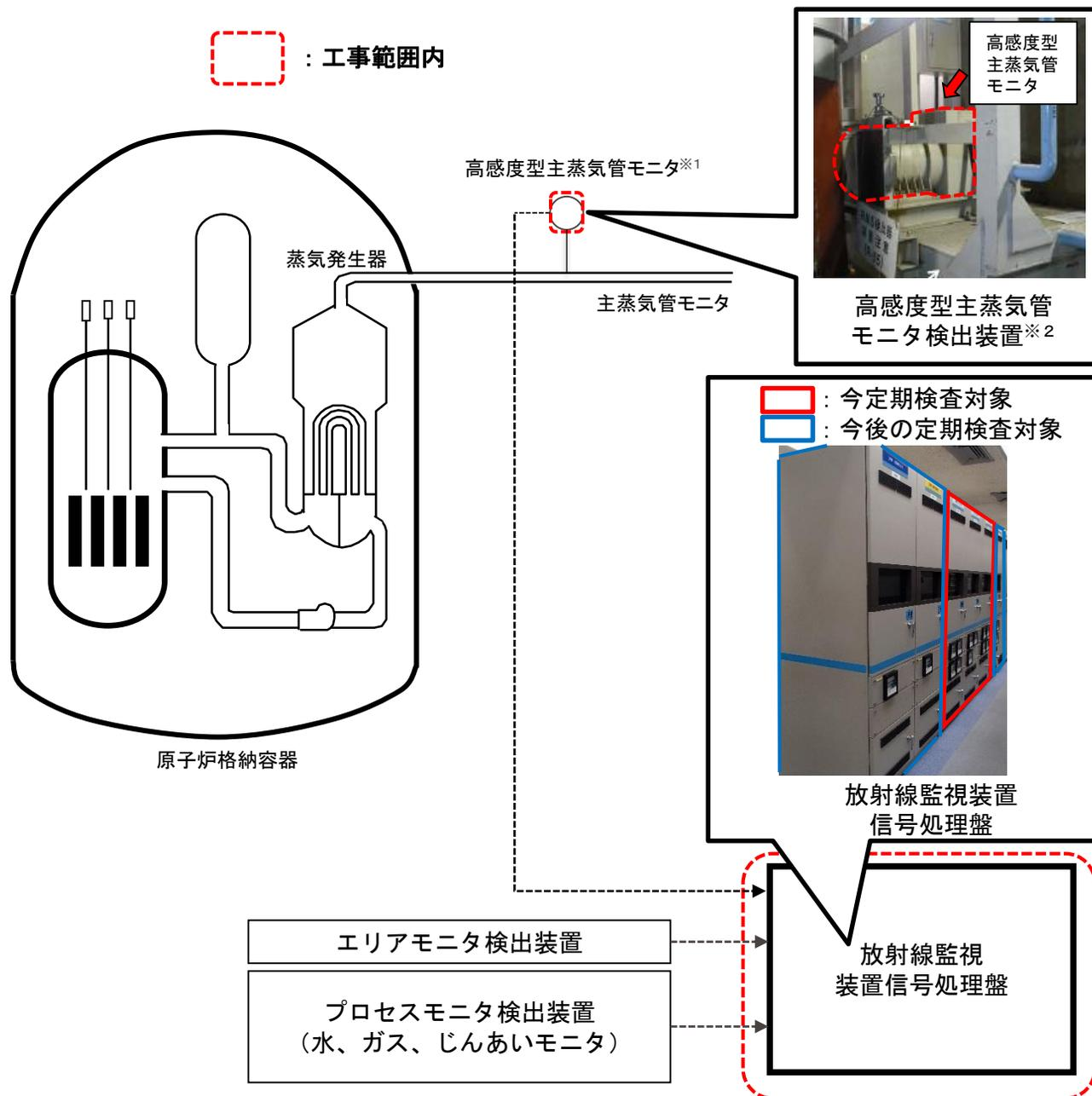
※<sup>1</sup> 各蒸気発生器（計3台）の主蒸気管に1台ずつ設置
