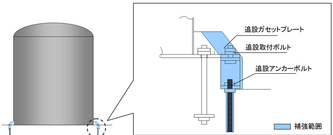
その他、支持脚の補強、胴板の補強、架台の補強を実施しました。
