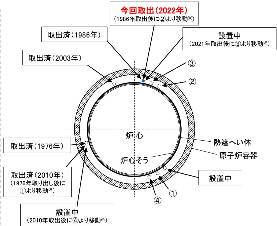
※カプセルの設置位置により中性子の照射量が異なるため、照射試験片の取出し時に将来の評価に適切な照射量となるよう、カプセルの移動を行っている。
