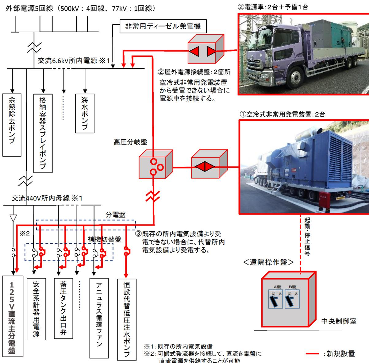
図-13 重大事故への対策(電源の確保:直流電源)
