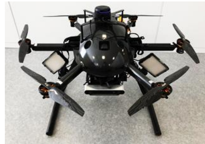
煙突内部点検用ドローン
