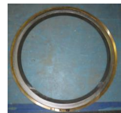
ポンプ入口継手部付近に使用していたガスケットの状況
