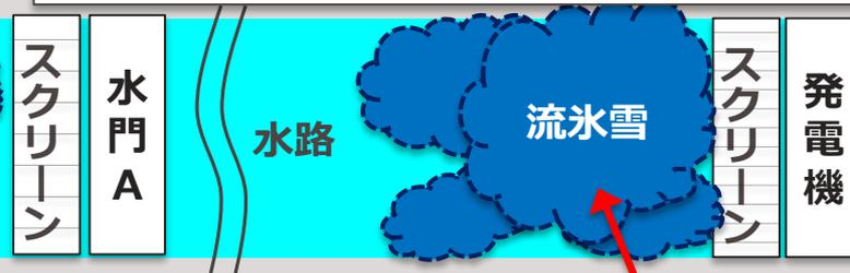
流氷雪が発電機の上流側に設置したスクリーンまで達した場合、発電水の流れを塞ぎ発電ができなくなる場合がある。
