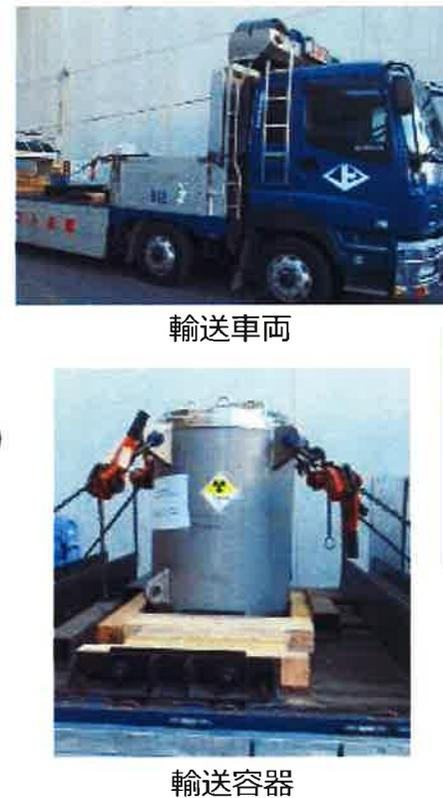
採取した試料を収納した輸送容器を輸送車両に積載し、分析機関まで運搬
