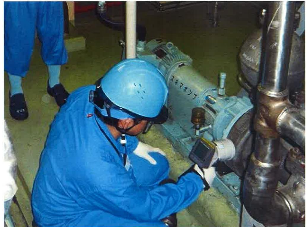
測定器を用いて機器表面の放射線線量率を測定
