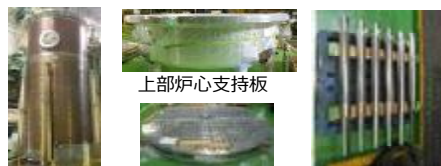
炉心そう 炉心板(上部・下部) 下部炉心支持柱 構造物各部品を工場製作中
