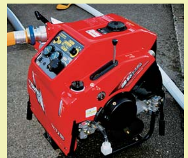
消防ポンプ (福島第一原子力発電所事故後に新設)
