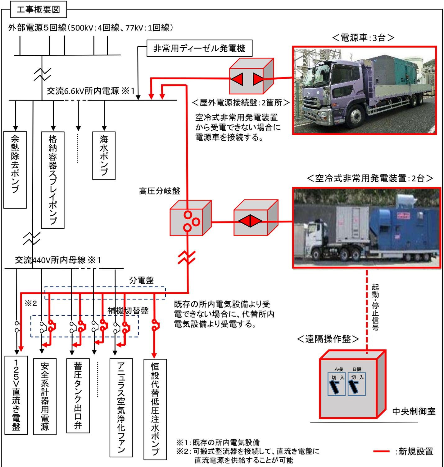
図-9 重大事故対策(電源の確保:直流電源)
