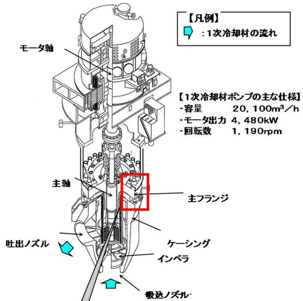
C号機 1次冷却材ポンプの点検概要図
