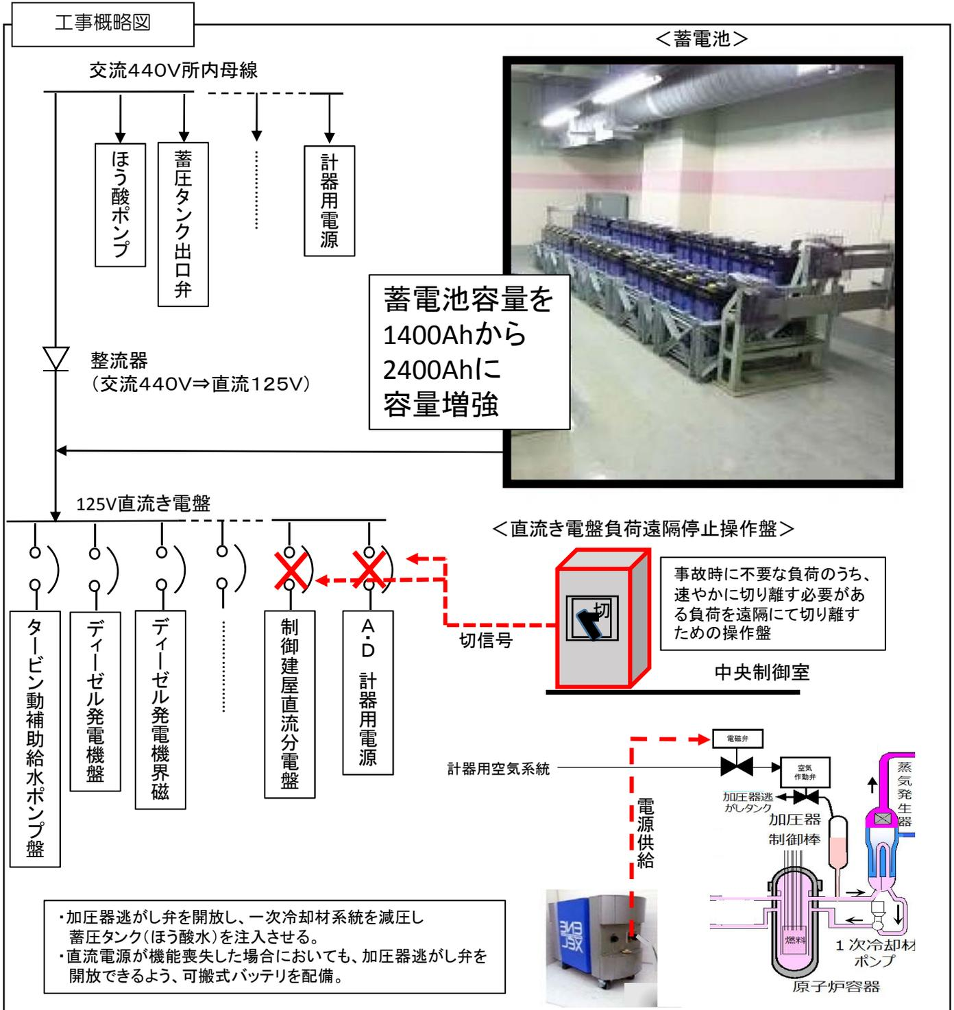
図-10 冷却機能の確保(炉心・格納容器の冷却)
