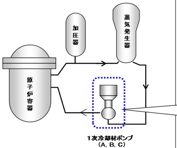
1次冷却材ポンプの概要図
