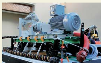
可搬式代替低圧注水ポンプ
