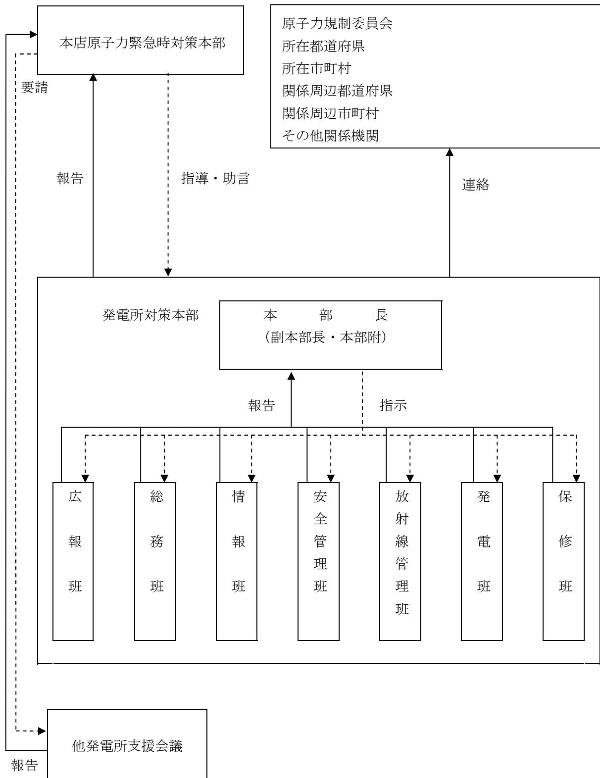
別図2-2-9 原災法第10条第1項に基づく通報(連絡)経路(発電所での事象発生)
