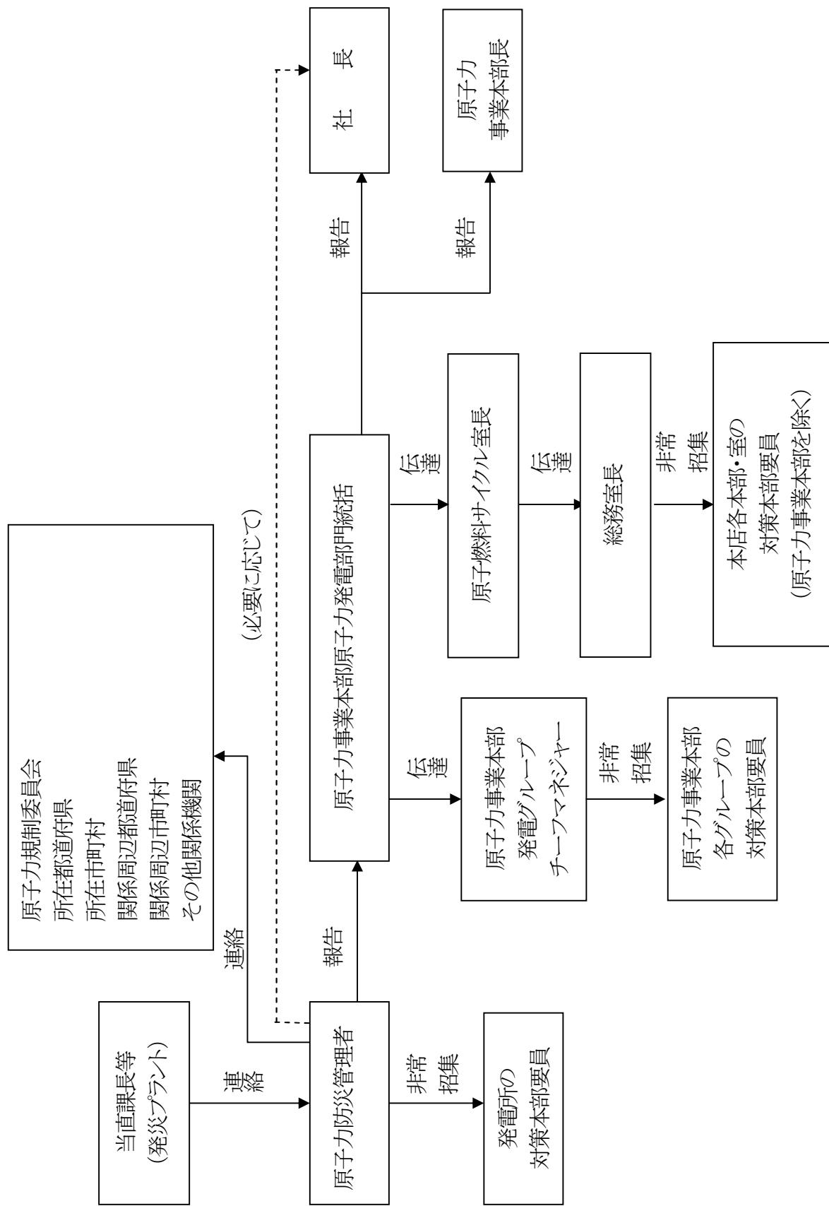
別図 2－2－8 発電所対策本部設置以降の報告連絡経路
