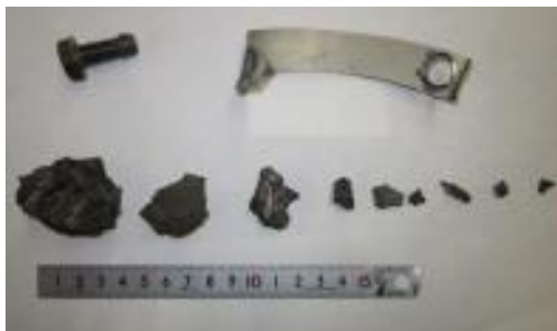
<過給機付近にて発見された金属片>
