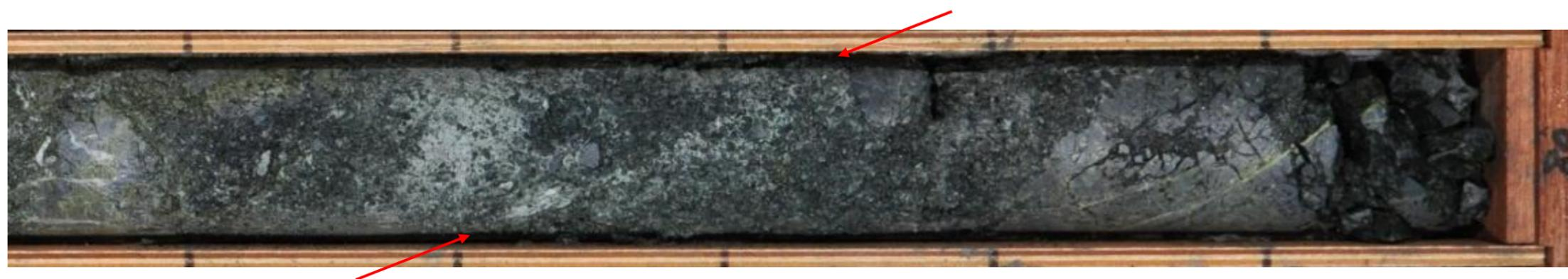
深度79.50~79.80m 輝緑岩中に見られる半固結の角礫状破砕部 (N28W/73E)。細礫を主体とし部分的に細粒分が混じる。
