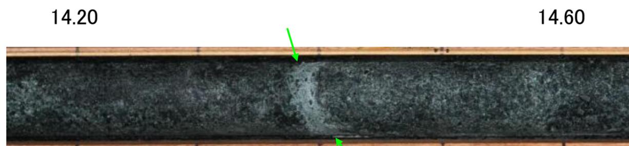
14.40m付近 幅2cmの淡緑色礫混じり粘土を挟在する。
