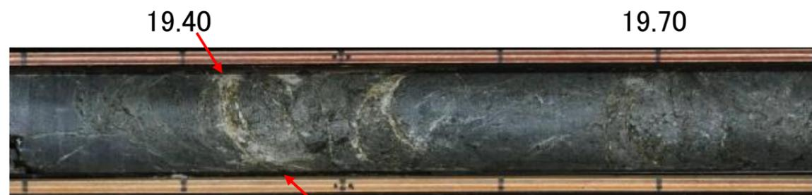
19.45m付近 幅1mmの粘土を挟在し、その間は弱いせん断を受け亀裂質。
