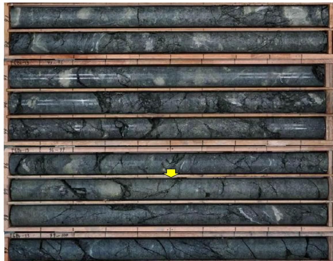
山頂トレンチで確認された破砕帯(N24E/77W)の延長は97.5m
