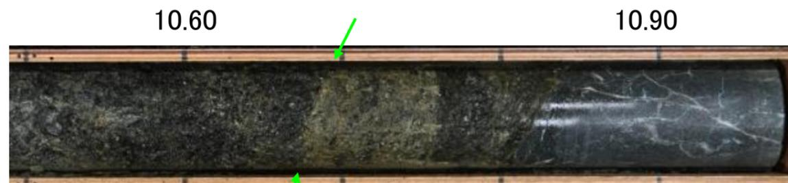
10.72m付近 幅約8cmの暗黄緑色砂混じり粘土状のすべり面。
