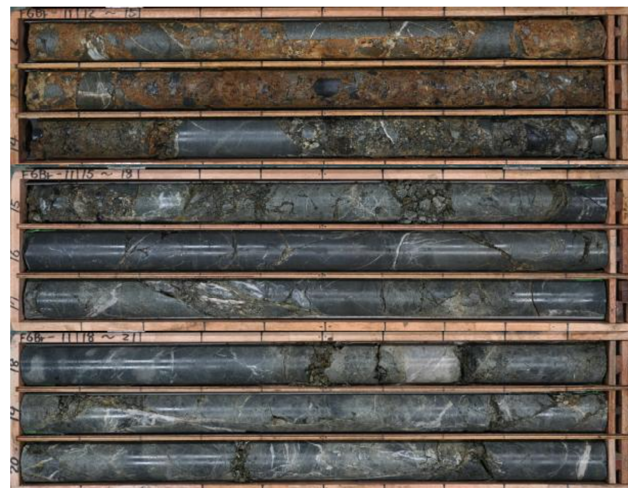
No.11ボーリング(孔口標高 EL.21.36m、掘進角度 70°、掘進長45m)
