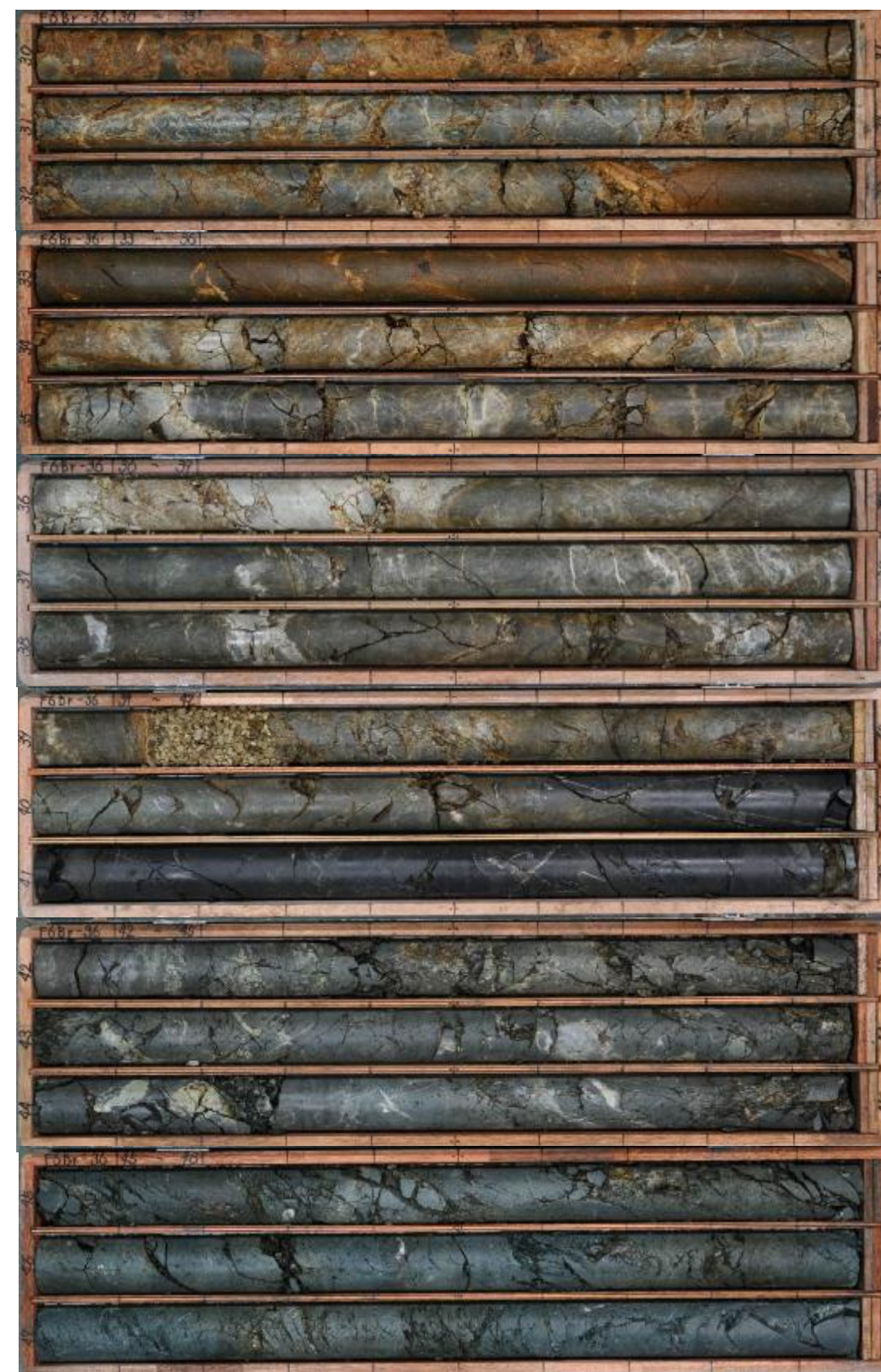
No.36ボーリング(孔口標高 EL.12.99m、掘進角度60°、掘進長140m)
