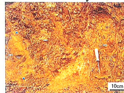
f3:粘土混じり砂礫状破碎部(走向N20°E, 傾斜75°E)
