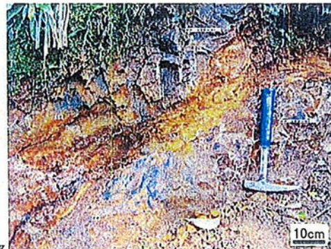
f3:粘土混じり砂礫状破砕部(走向N45W, 傾斜40E)
