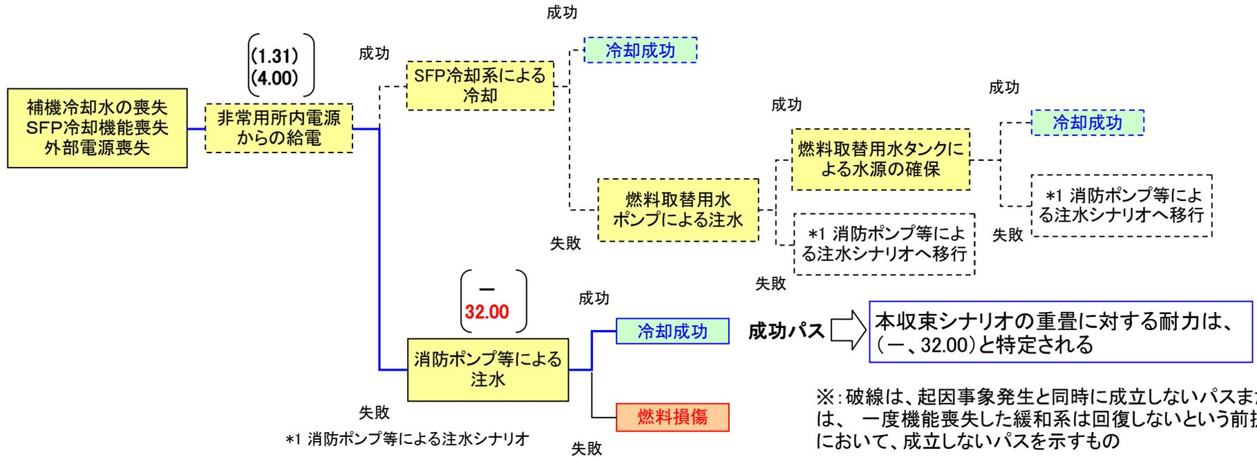
注) 消防ポンプは地震に影響のない場所に保管され、水源として用いられる海水は、津波の影響がない状況から使用する。
