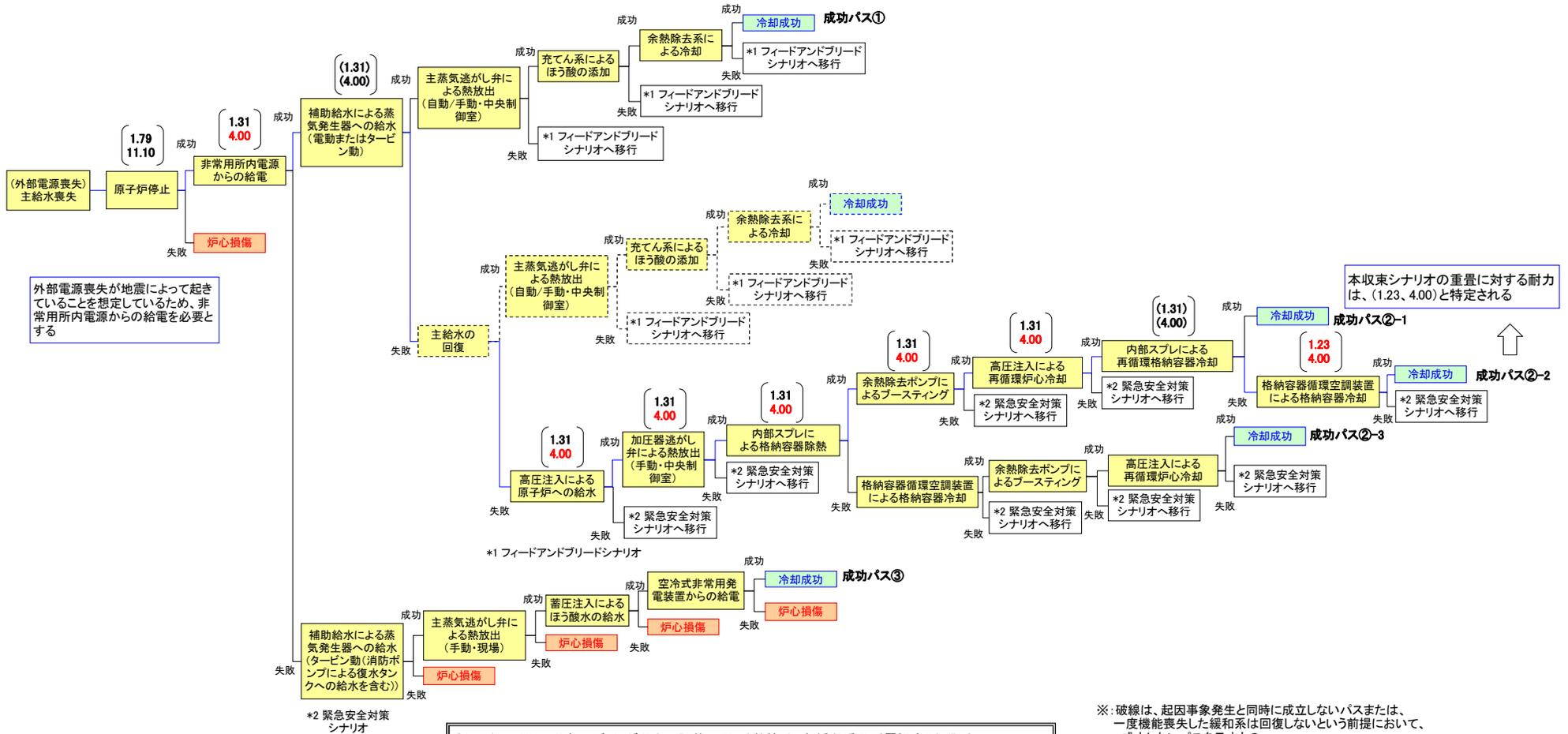
外部電源喪失が地震によって起きていることを想定しているため、非常用所内電源からの給電を必要とする
