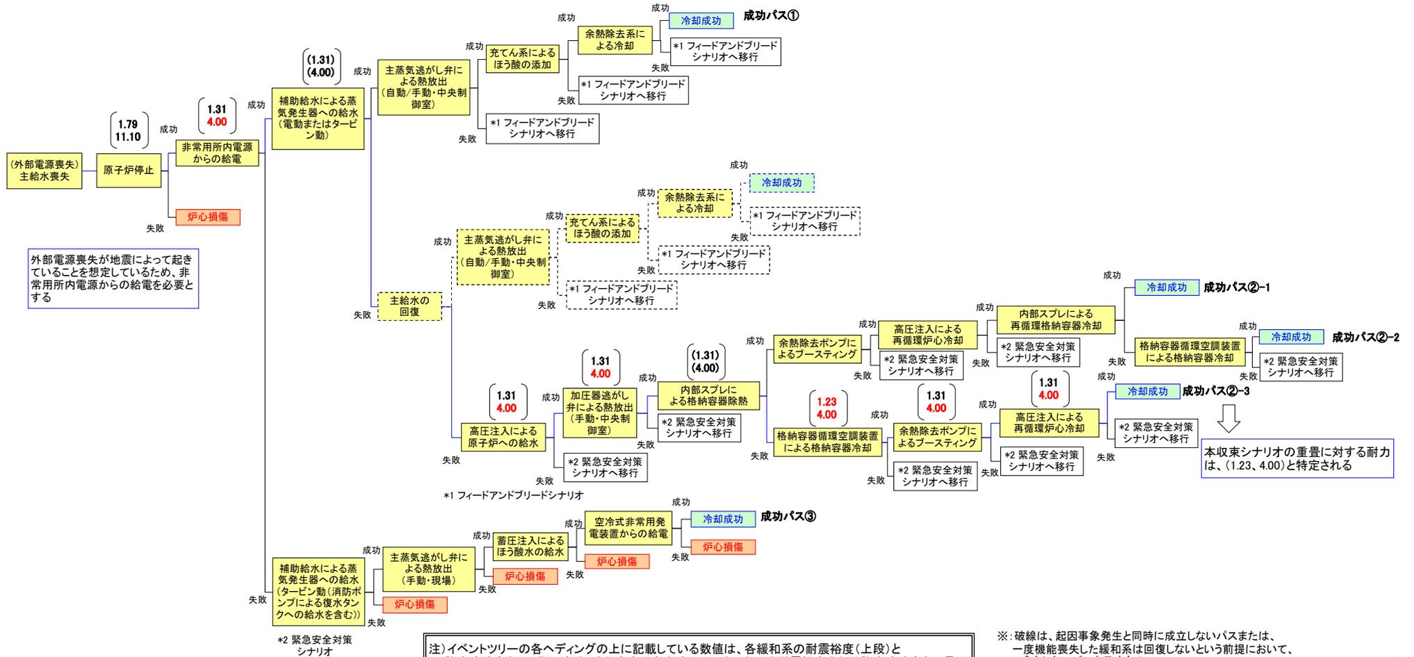
各シナリオの重畳に対する耐力の評価結果 (重畳：炉心損傷 (津波による起因事象をベースとした評価))
