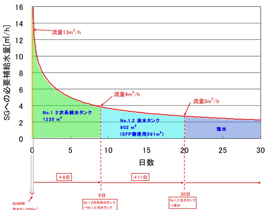
図 2 水源と補給水量の変化
