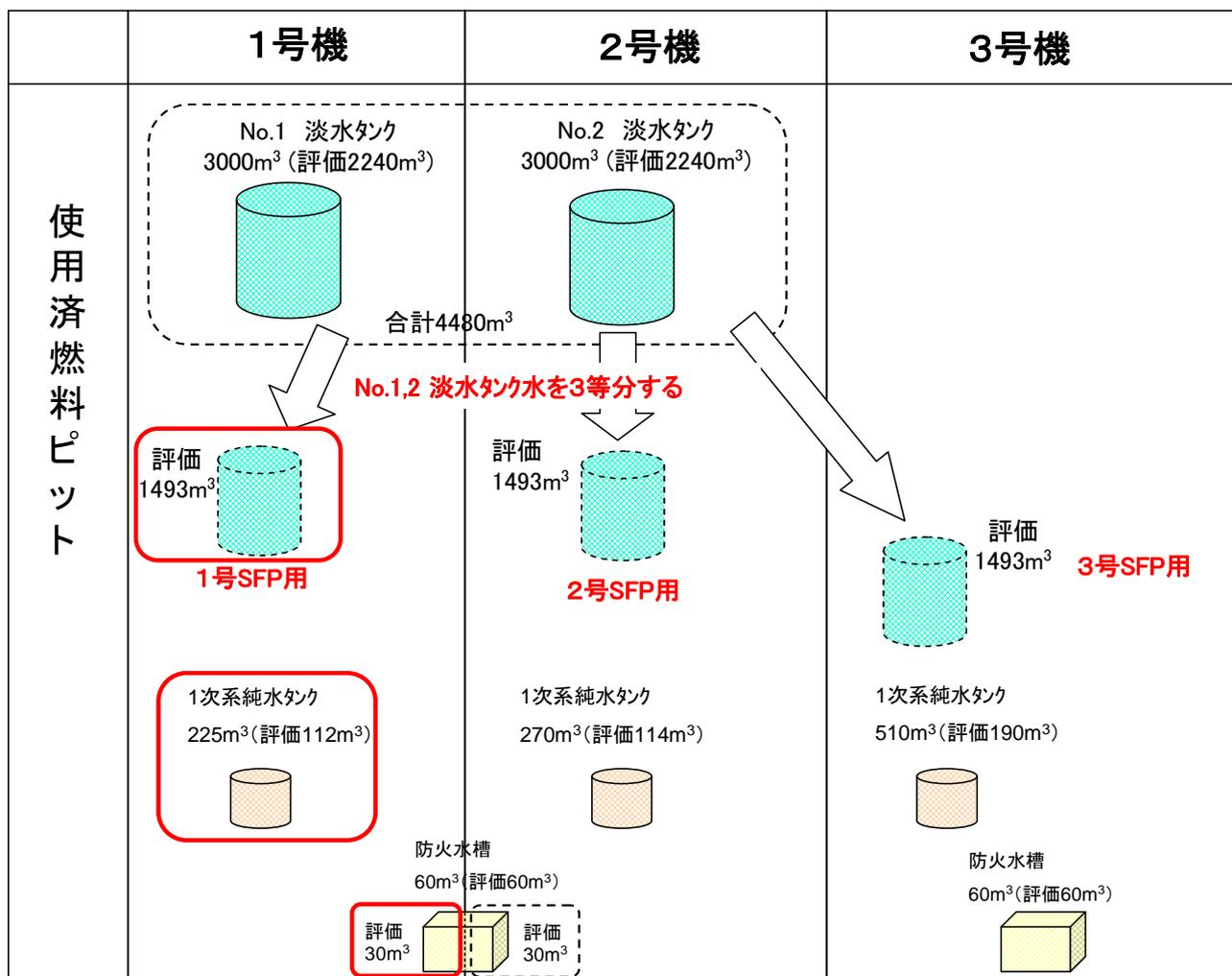
( )内の評価に使用する保有水量: 1次系純水タンク、防火水槽は運用水位、淡水タンクは水位低警報設定の保有水量とした。
