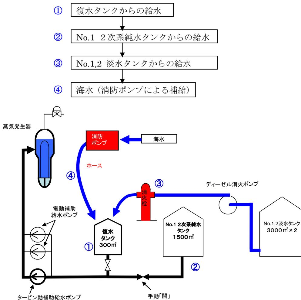
2. 蒸気発生器への補給水源
