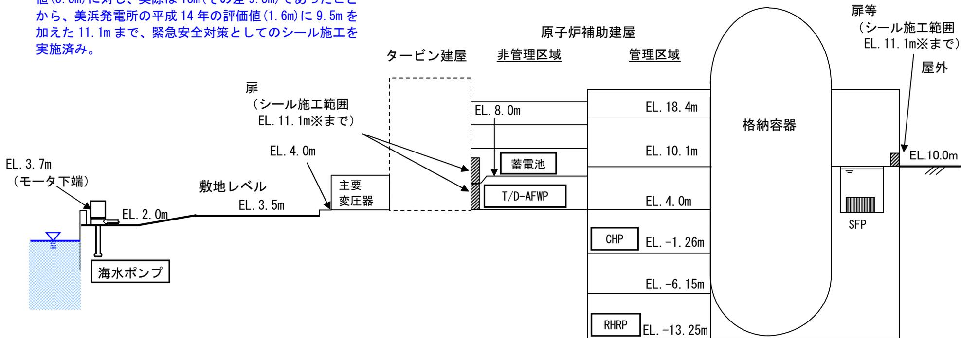
注) T/D-AFWP : タービン動補助給水ポンプ
