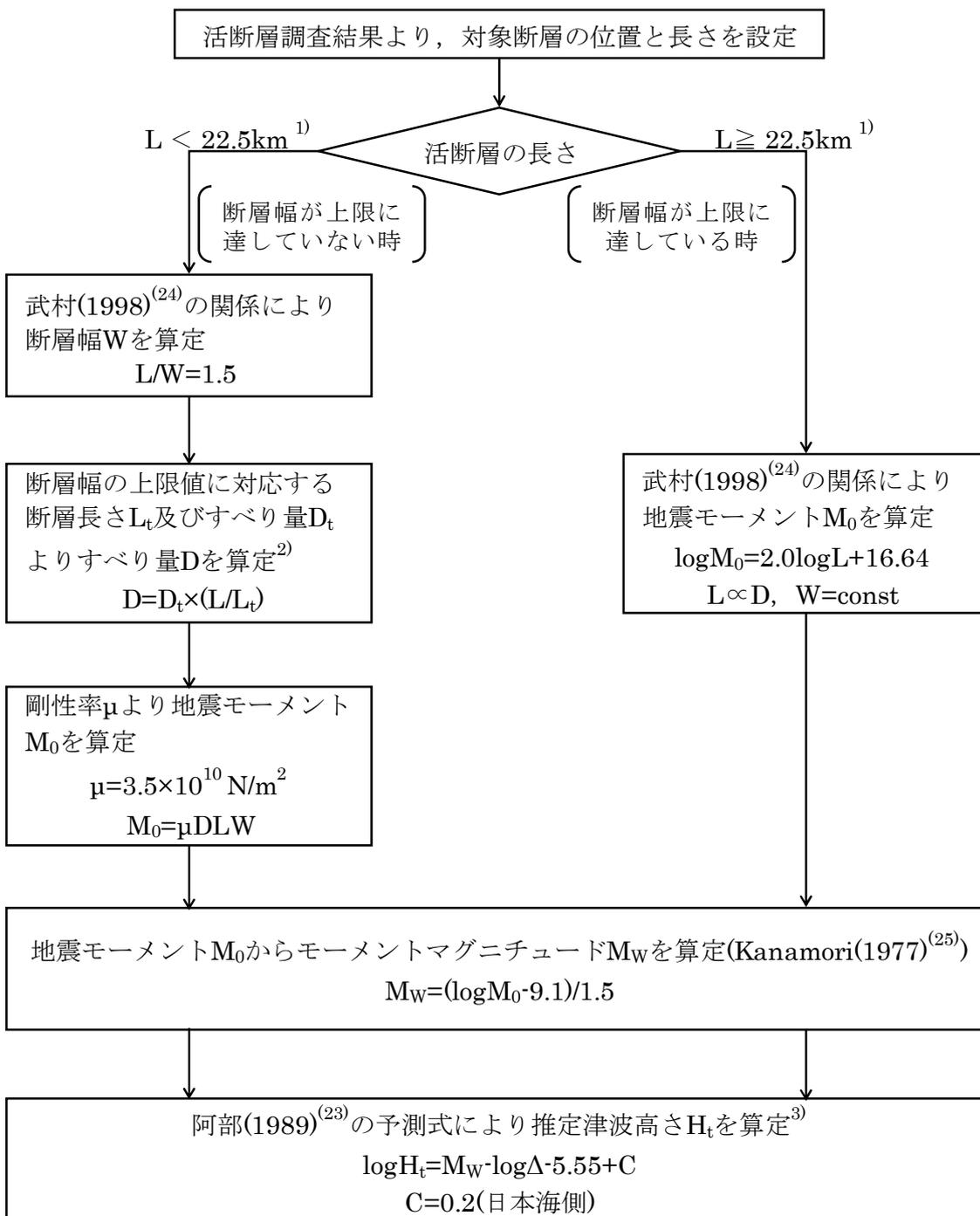
1) 断層幅の上限  $W_t$  は、地震発生層の厚さ  $H_e$  を 15km とし、傾斜角  $\delta$  を  $90^\circ$  ( $45 \sim 90^\circ$  のうち  $M_w$  が最大となる値) とした際には、 $W_t = H_e / \sin \delta = 15 \text{ km}$  となる。断層幅の上限に対応する断層長さ  $L_t$  は、 $L_t = 1.5 W_t = 22.5 \text{ km}$  となる。
