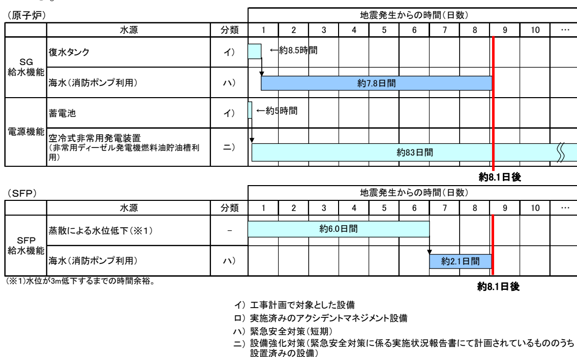
図 5-(6)-13 運転時における給水及び電源機能の継続時間評価結果（地震時）
