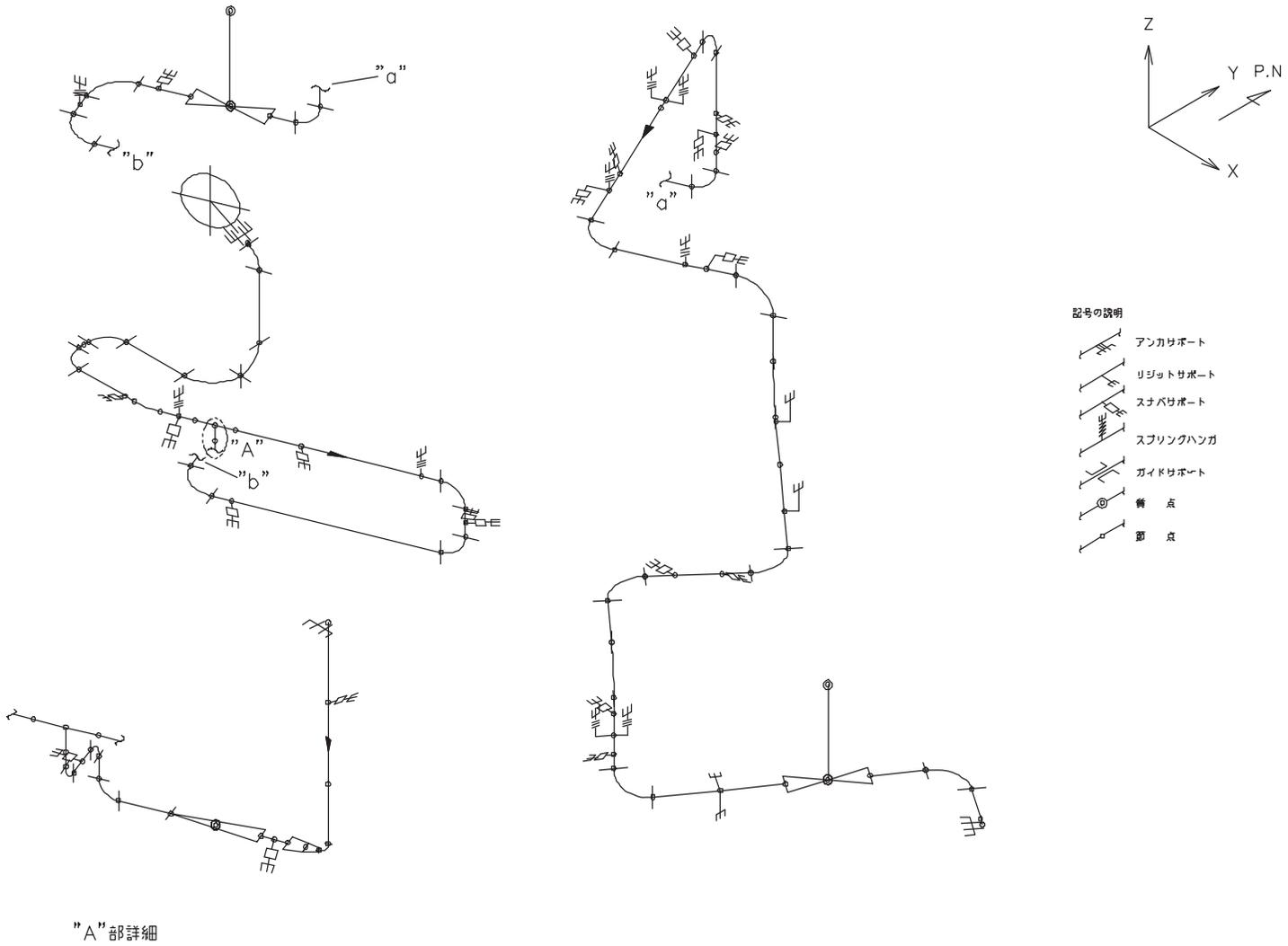
図 3 - 6 地震応答解析モデル (配管系の例)
