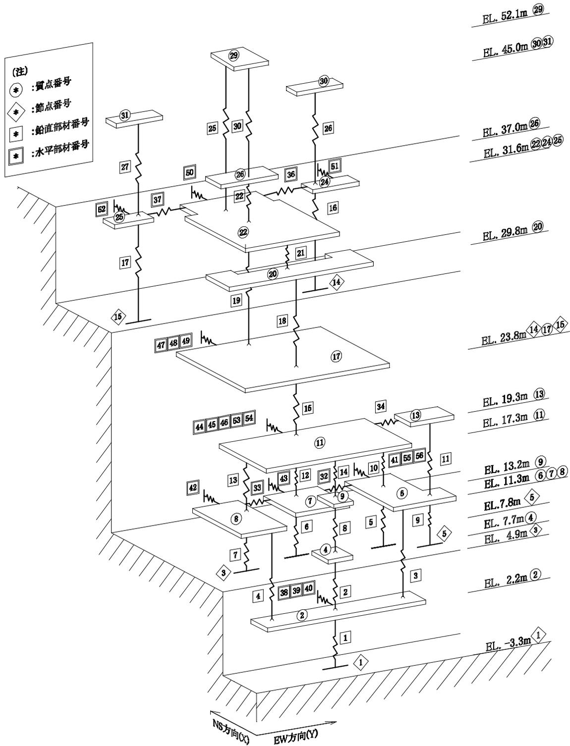
図 2 - 3 原子炉補助建屋の解析モデル(水平)
