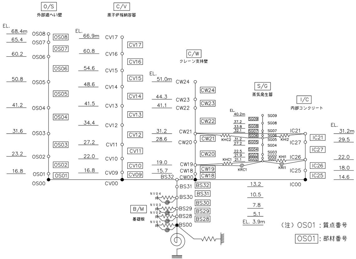
図 2 - 1 原子炉建屋の解析モデル (水平)
