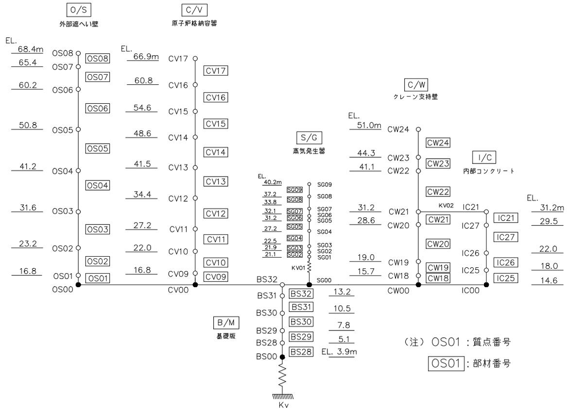
図 2 - 2 原子炉建屋の解析モデル (鉛直)
