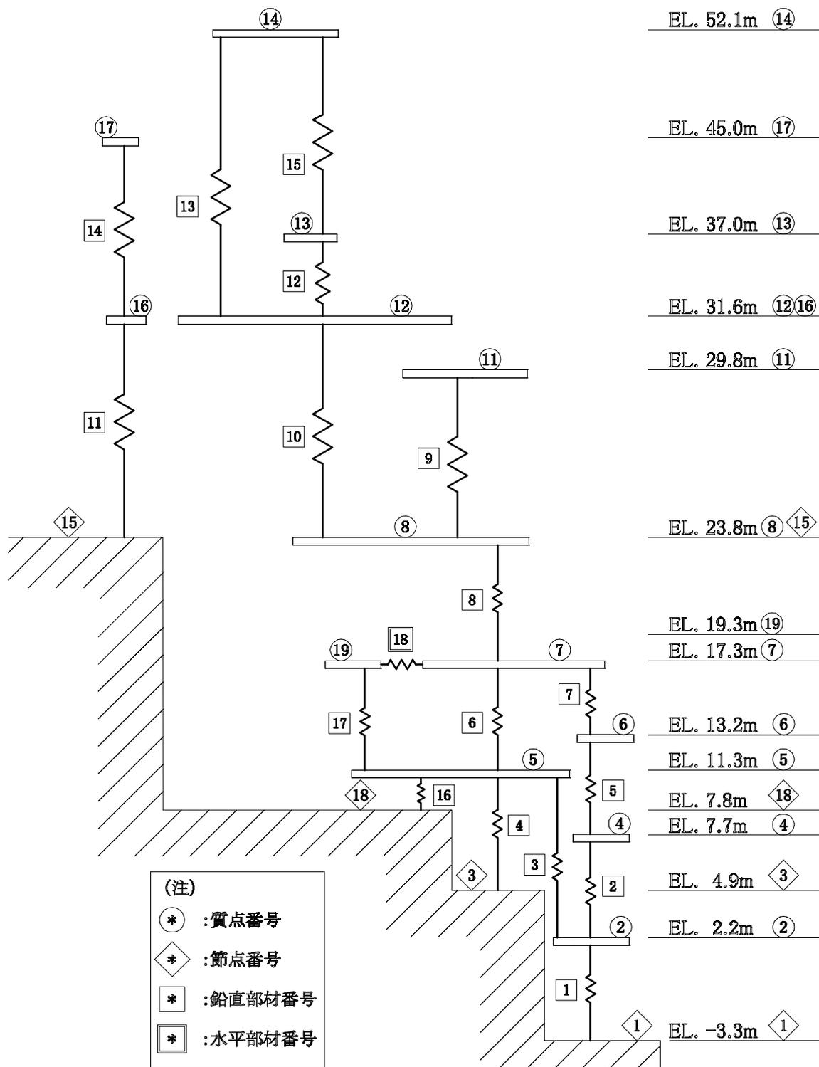
図 2 - 4 原子炉補助建屋の解析モデル(鉛直)
