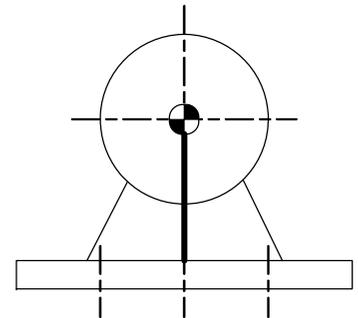
図 3 - 5 地震応答解析モデル (補機の例)
