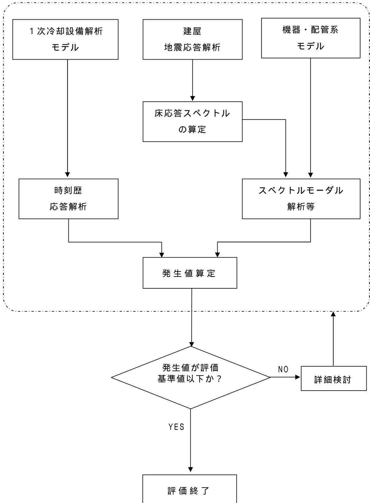
図 3 - 1 構造強度の評価手順
