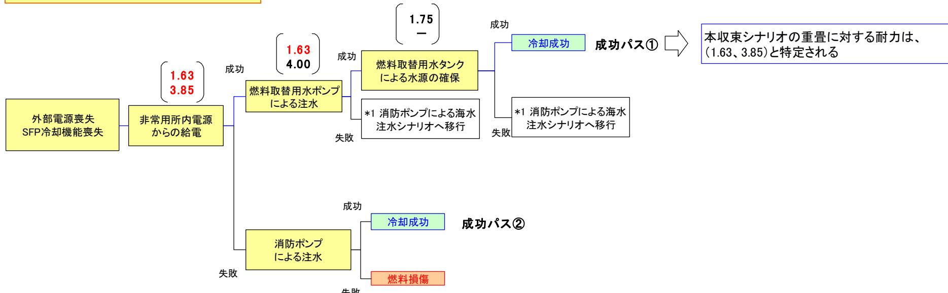
注)消防ポンプは地震による影響がない場所に保管され、水源として用いられる海水は、津波の影響がない状況から使用する。
