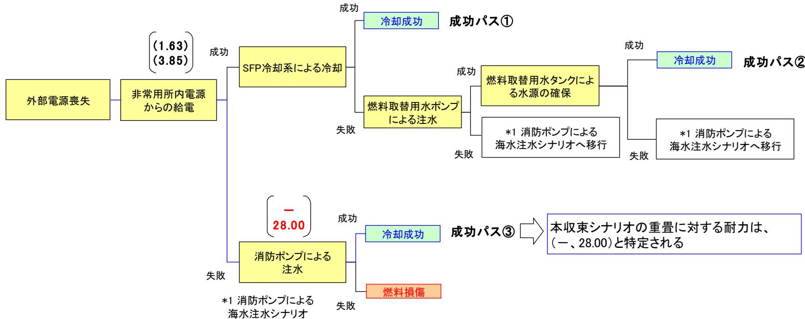
注) 消防ポンプは地震による影響がない場所に保管され、水源として用いられる海水は、津波の影響がない状況から使用する。
