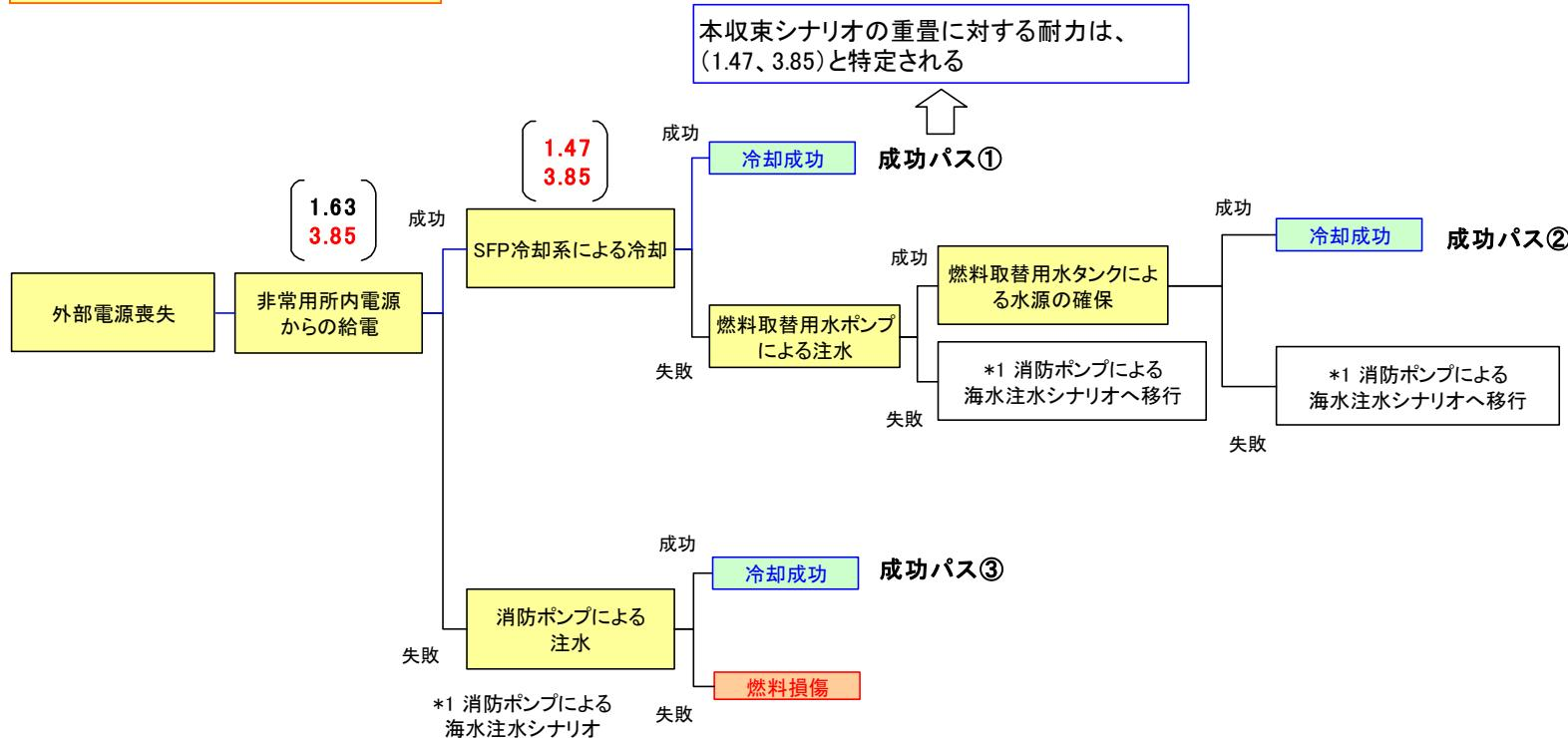
注)消防ポンプは地震による影響がない場所に保管され、水源として用いられる海水は、津波の影響がない状況から使用する。
