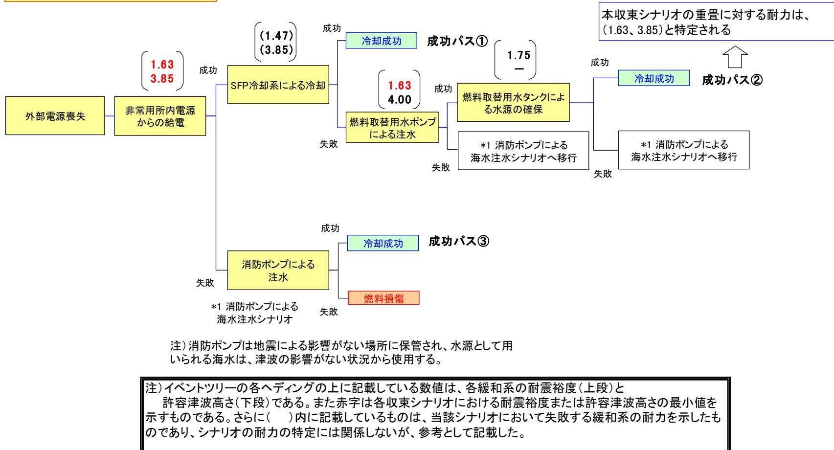
各シナリオの重畠に対する耐力の評価結果（重畠：SFP（地震による起因事象をベースとした評価））
