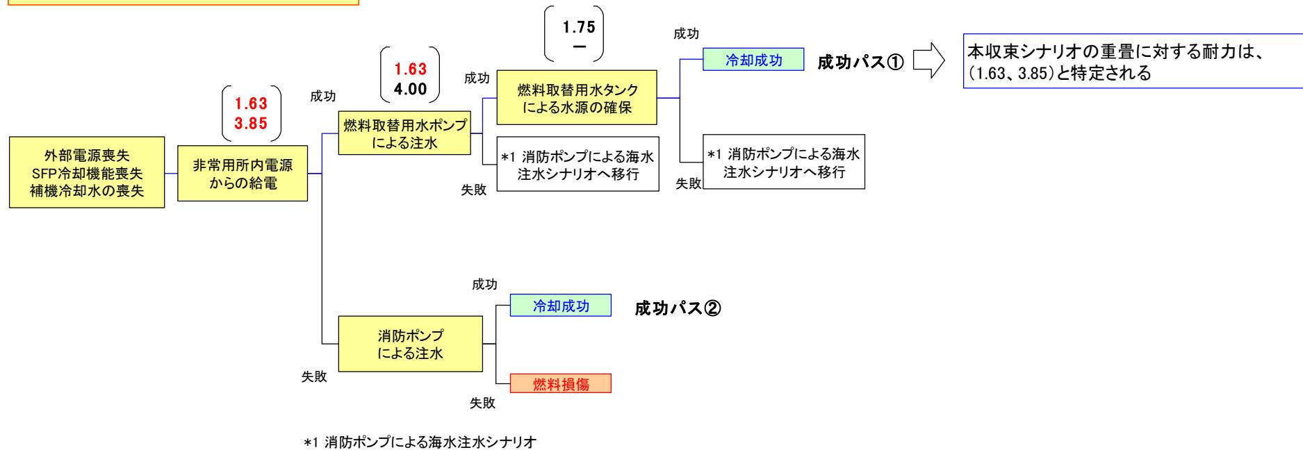
注)消防ポンプは地震による影響がない場所に保管され、水源として用いられる海水は、津波の影響がない状況から使用する。
