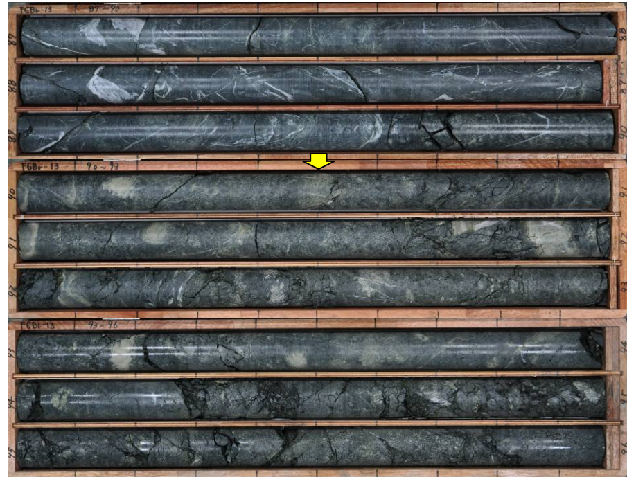
No.13ボーリング(孔口標高 EL.45.77m、掘進角度 70°、掘進長100m)
