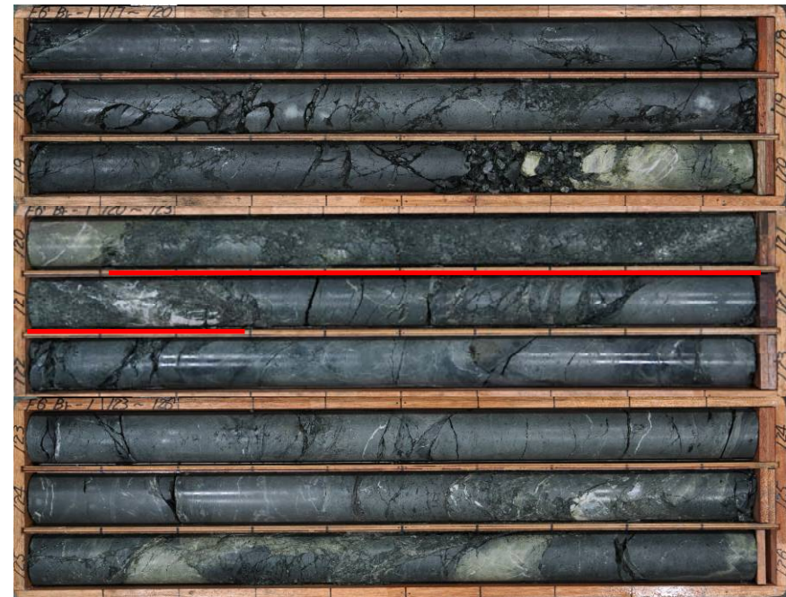
No.1ボーリング(孔口標高 EL.9.76m、掘進角度 70°、掘進長135m)
