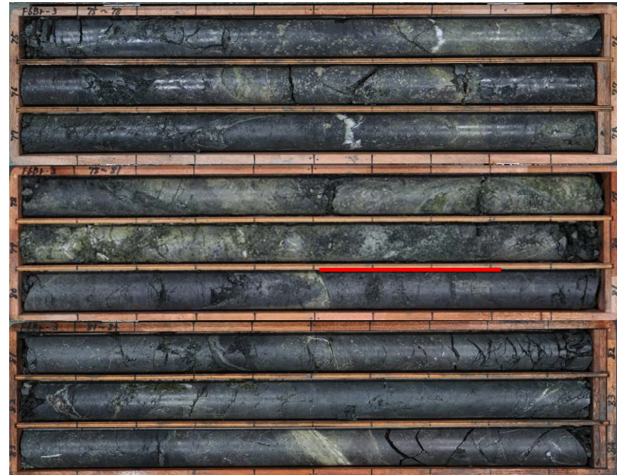
No.3ボーリング(孔口標高 EL.9.29m、掘進角度 70°、掘進長120m)
