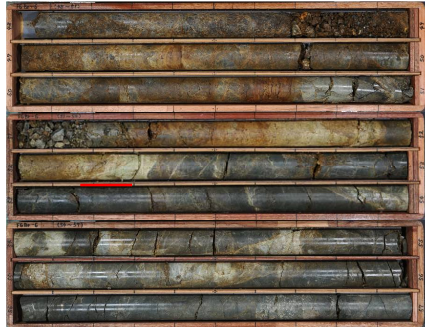
No.6ボーリング(孔口標高 EL.22.12m、掘進角度 75°、掘進長65m)
