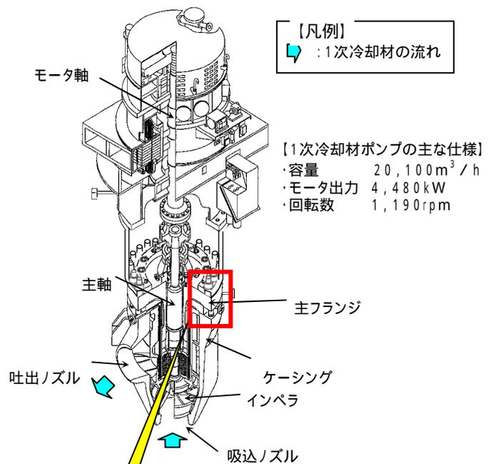
C号機 1次冷却材ポンプの点検概要図
