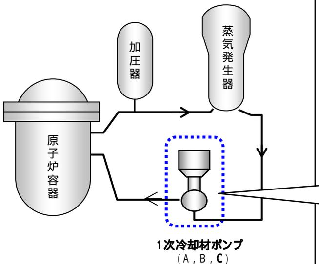
1次冷却材ポンプの概要図
