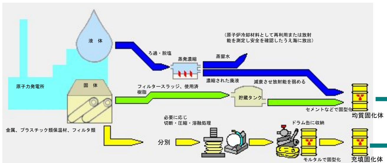
■ 原子力発電所で使用した水などの液体廃棄物は蒸発濃縮処理し、セメントなどで固型化します。
