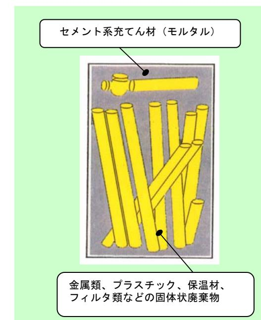
保温材・フィルタ類などを圧縮し、セメント系充てん材（モルタル）で一体となるよう固型化したもの
